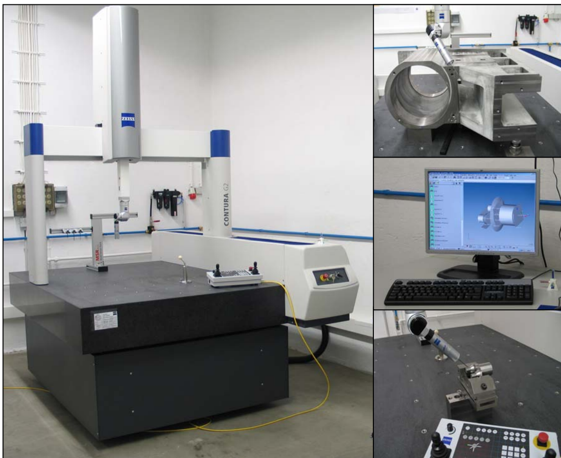
Abbildung zeigt Messmaschine im klimatisierten Messraum mit Messanwendungen
